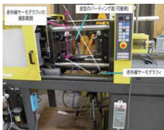
図 6 赤外線サーモグラフィの設置位置
