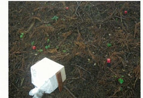
土砂受け箱設置状況
