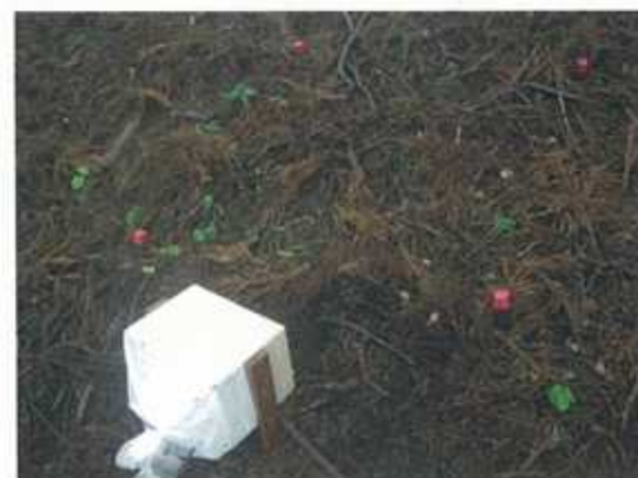
土砂受け箱設置状況
