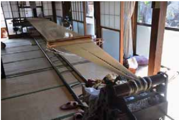
図 15 機巻き工程風景
