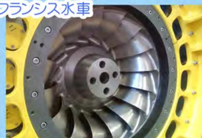
流れる水の圧力で回転する水車タービン
