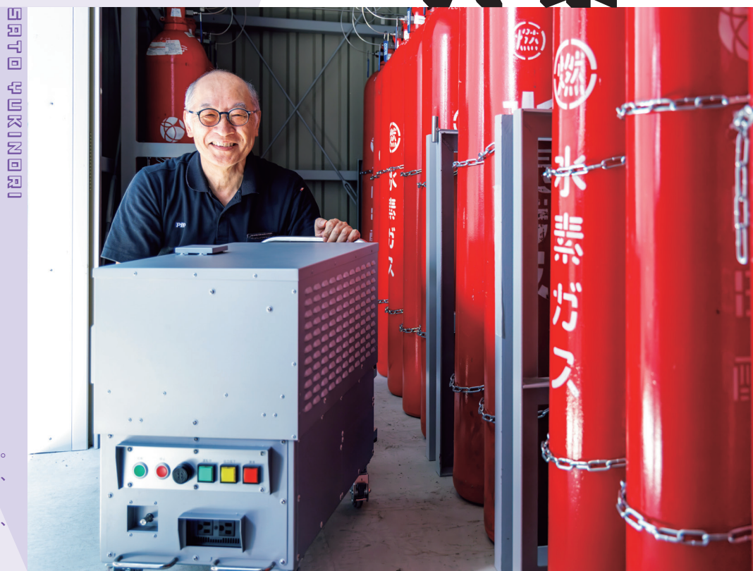
開発中の中型燃料電池発電機。赤色の高圧水素容器から水素を注入して発電する
