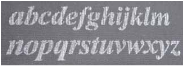
図 10 加工条件：上下動作速度 60rpm の結果
