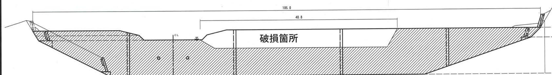
正面図 No. 1谷止工 (コンクリート) 構造図
