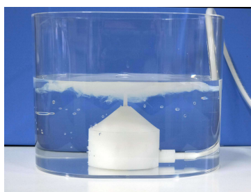
試作中の小型立体タイプの噴煙実験装置
