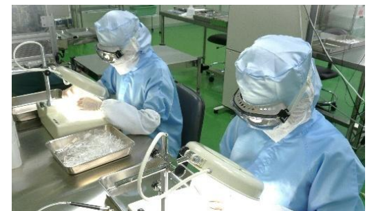
クリーンルーム内での組立
