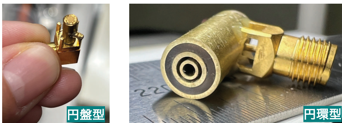
図 3 円盤・円環型の高周波強力超音波トランスデューサ
