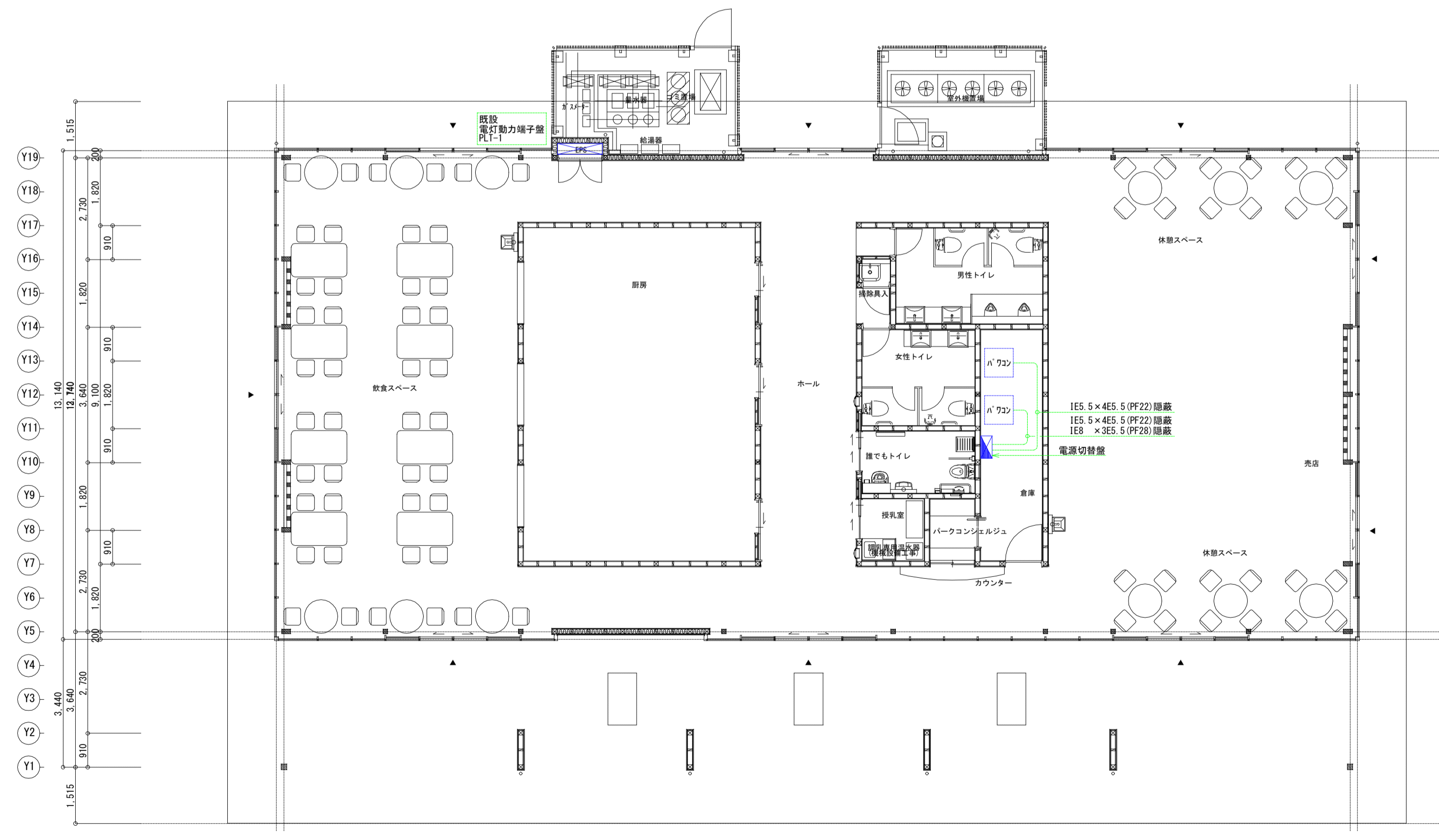
非常電源設備平面図 S=1:100
