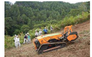
ラジコン式機械による地拵の実証
