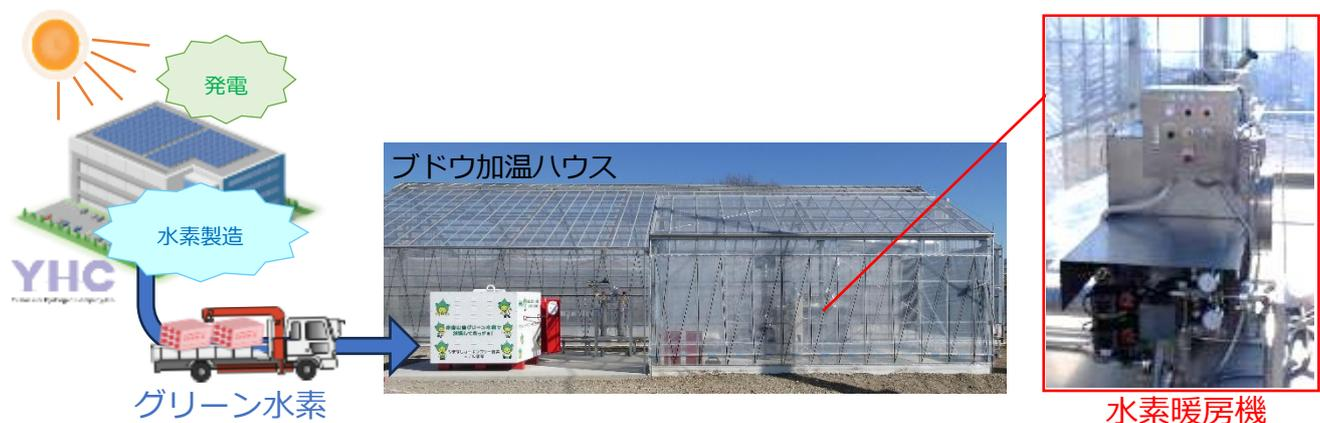
本実証実験では、この「水素暖房機」によるハウス内の温度制御や水素の使用量、ハウスシャインマスカットの生育への影響などを、3年間にわたり調査します。
