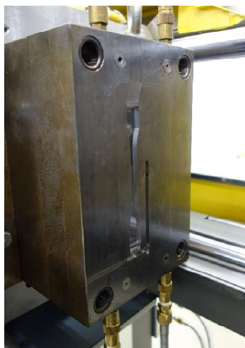
ダンベル試験片の金型(左)と成形したダンベル試験片(右)
