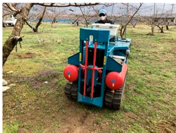
第3図 グロースガンによる圧縮空気注入処理
