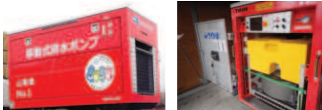
■ 浸水被害対応用の排水ポンプ
