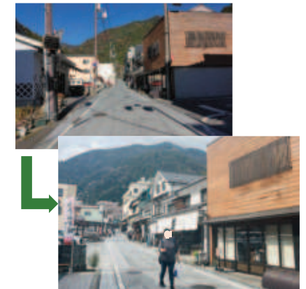
■ 無電柱化による景観の向上
