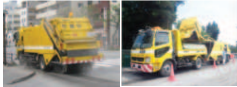
■ 路側清掃車による降灰除去 提供: 鹿兒島市
