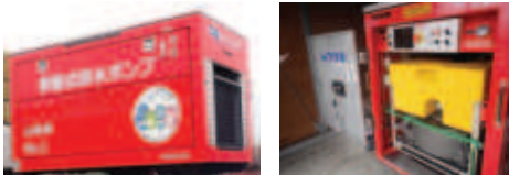
■ 浸水被害対応用の排水ポンプ
