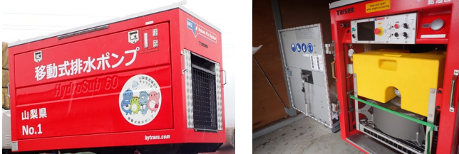
■ 浸水被害対応用の排水ポンプ
