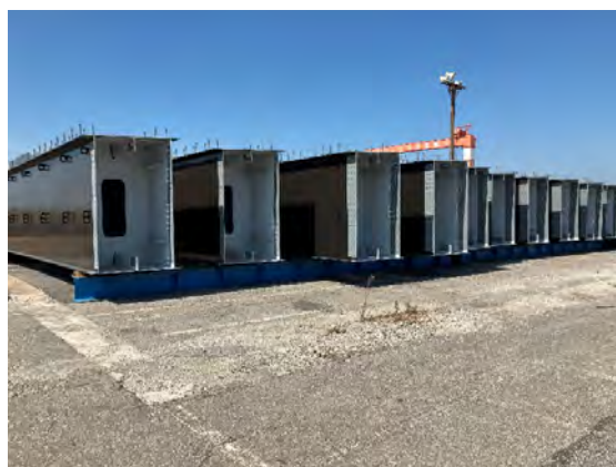
工場製作(塗装完了)
