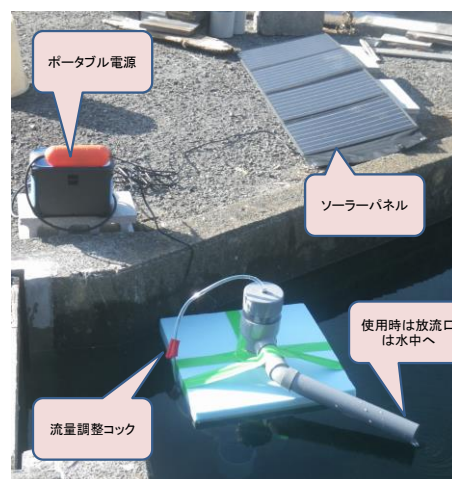
図3 自作放流用器具の設計（左）と野外での使用風景（右）
