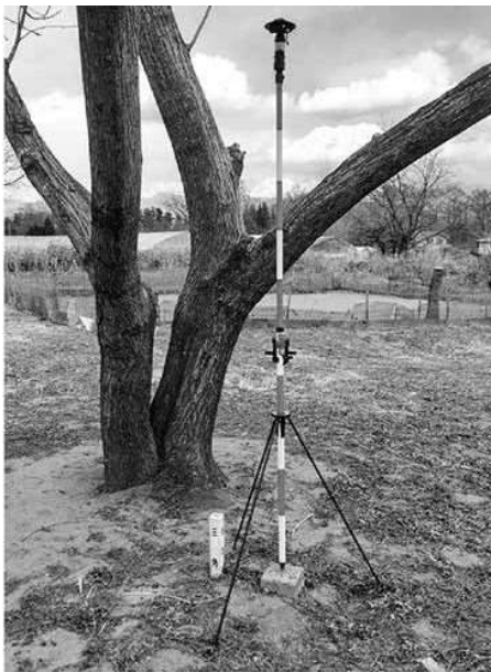
写真2 基準点(三等三角点)でのRTK測位試験
