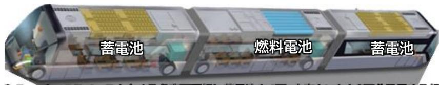
2.5m×3mのスペースを有する各車両屋根に蓄電池を4両、水素タンクを2両分設置する想定
