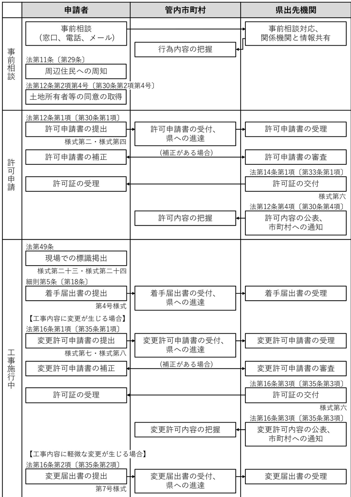
図 1-18 許可申請が必要な工事の手続きの流れ（県出先機関が処理する場合、1/2）
