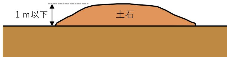
**図 1-10** 面積が 500 m<sup>2</sup>超であっても、土石の堆積を行う土地の地盤面の標高と堆積した土石の表面の標高との差が 1 m を超えないもののイメージ図
