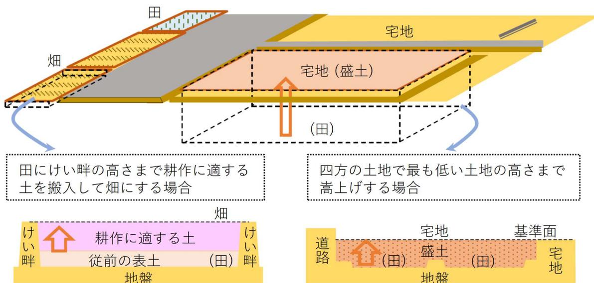
図 1-12 窪地を四方の土地の高さに合わせて高上げる盛土のイメージ
