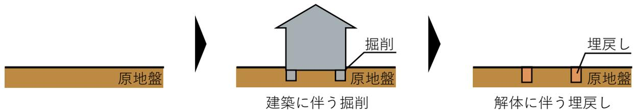
図 1-15 建築物の建築・解体に伴う掘削・埋戻し
