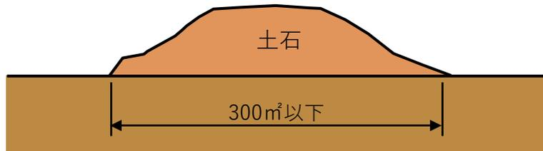
**図 1-9** 高さが 2 m 超であっても、土石の堆積を行う土地の面積が 300 m<sup>2</sup>を超えないもののイメージ図
