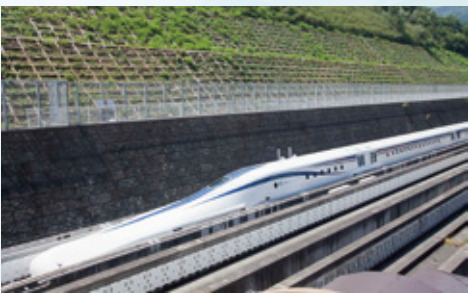
営業線仕様のL0（エル・ゼロ）系改良型試験車。現在はこの車両で走行試験が行われている。 (都留市: 山梨実験センター付近)
