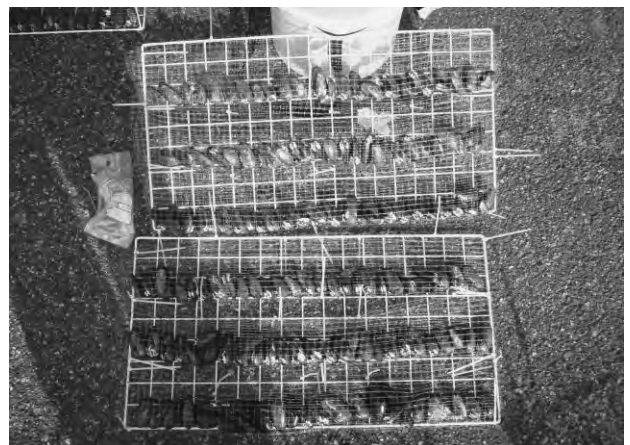
図14 野外実験での懸架式二枚貝設置方法
