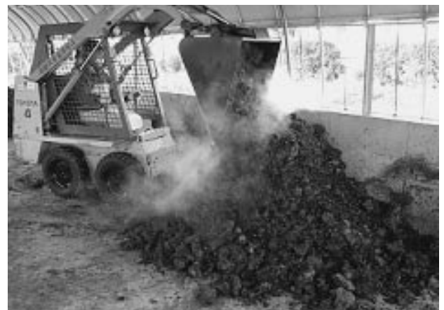
写真-6 重機による切り返し
