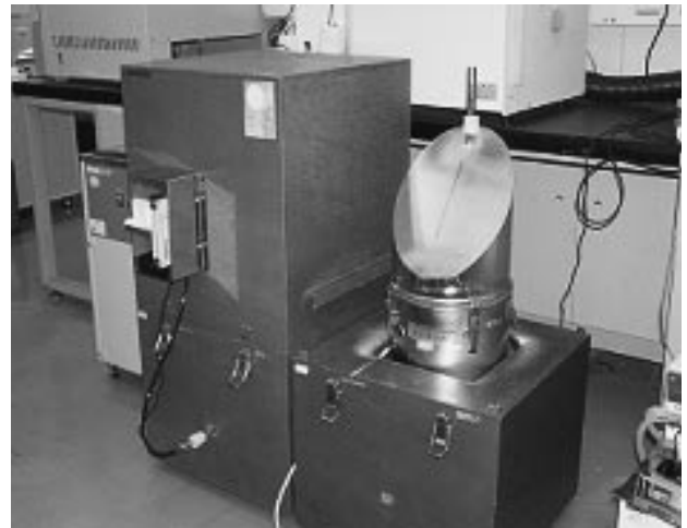
写真-3 小型堆肥化実験装置
