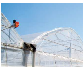
自動換気装置
