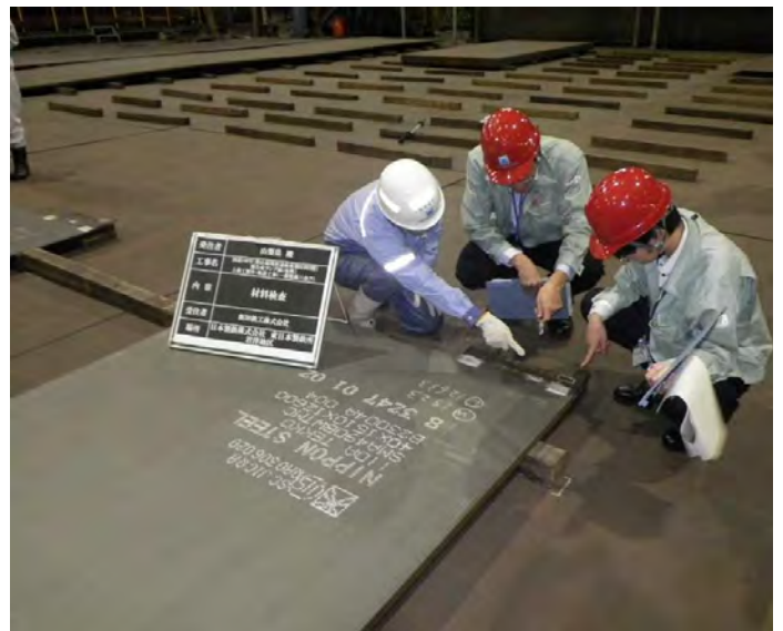
鋼材検査状況
