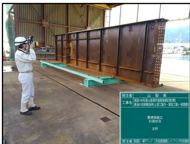
橋桁検査状況
