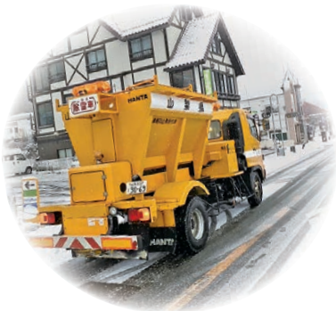
凍結防止剤散布の様子
