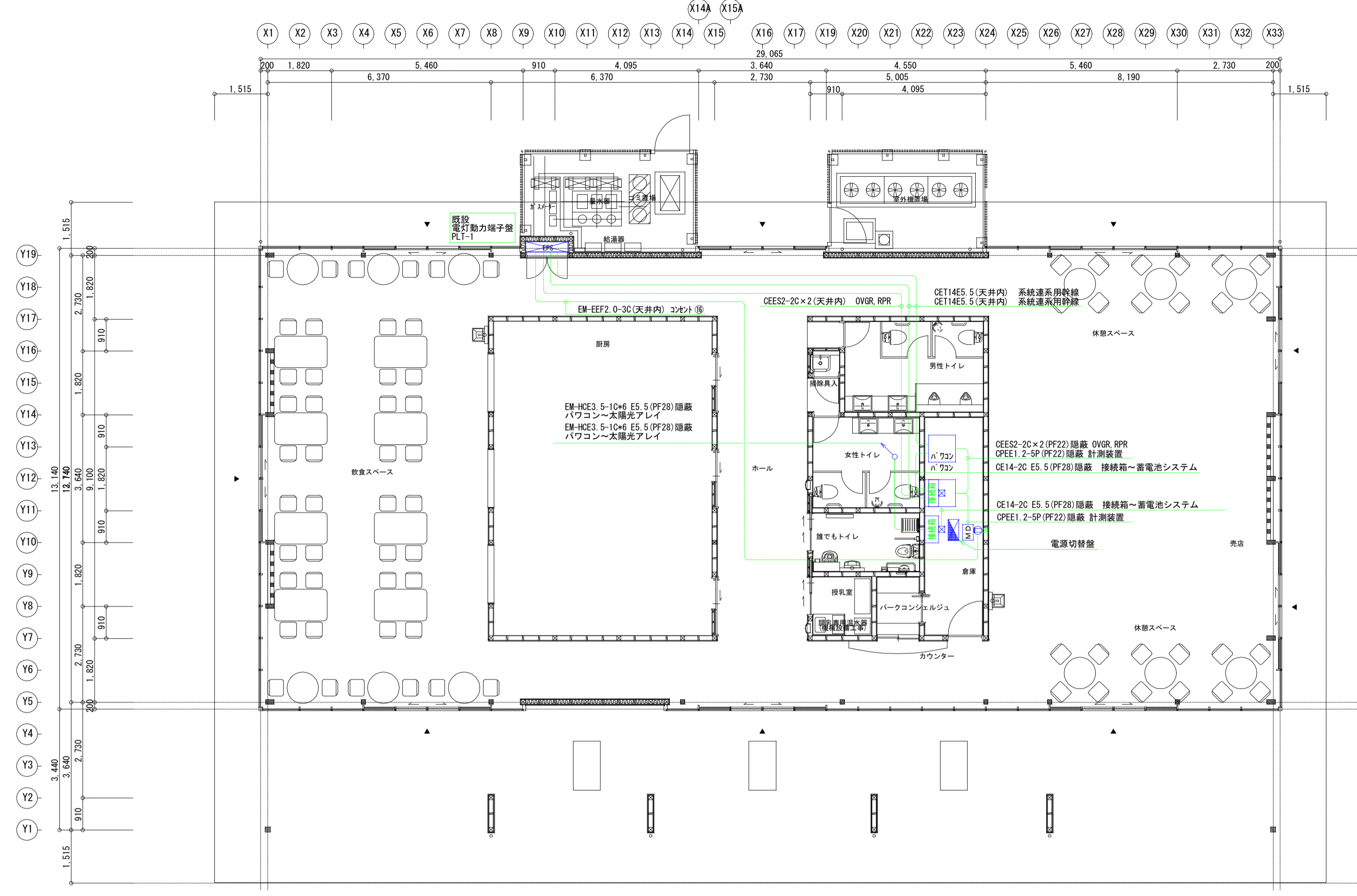
太陽光設備 平面図 S=1:100
