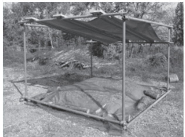
写真2 チップ堆積塊モデルによる乾燥試験
