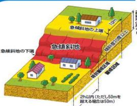
傾斜度が30度以上、高さが5m以上ある土地が崩壊する自然現象
