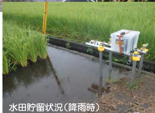
写真 4.5② 田んぼダムの取り組み（南アルプス市における実証実験の様子）
