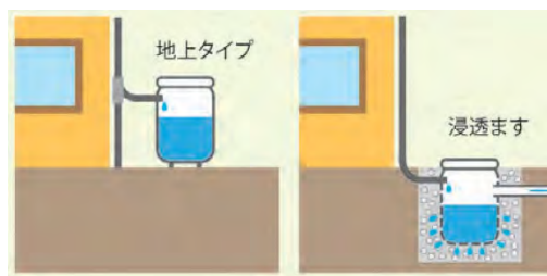
雨水貯留浸透施設のイメージ
