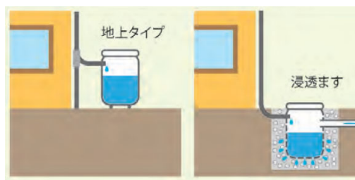
雨水貯留浸透施設のイメージ
