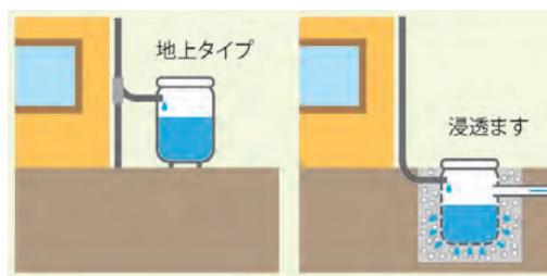
雨水貯留浸透施設のイメージ
