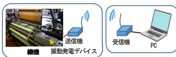
図 27 「連続モード」による織機の見守り通信システムの概略
