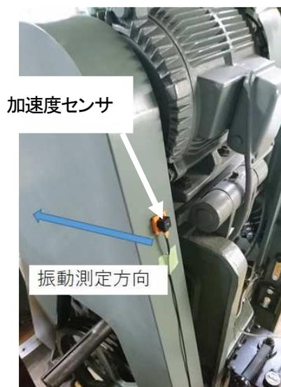
図 24 織機に貼付した加速度センサ
