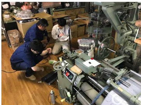
図 23 織機の振動解析の状況
