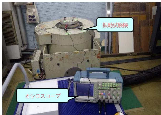
図 21 振動試験機を用いた連続モードの機器設置状況
