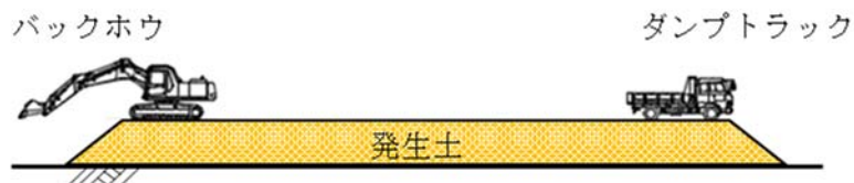
図2-4 (3) 西之宮地区発生土仮置き場における主な施工手順（発生土搬出）
