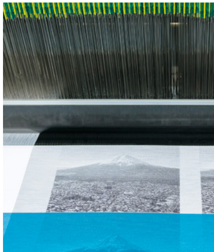
取り込んだ写真の階調を高精度に再現し、織物組織に変換する技術(織物デザ法)を開発。さらに豊かな階調表現を可能にした(上)富士山を背景とした富士吉田市街の風景をジャカード織で再現(下)
