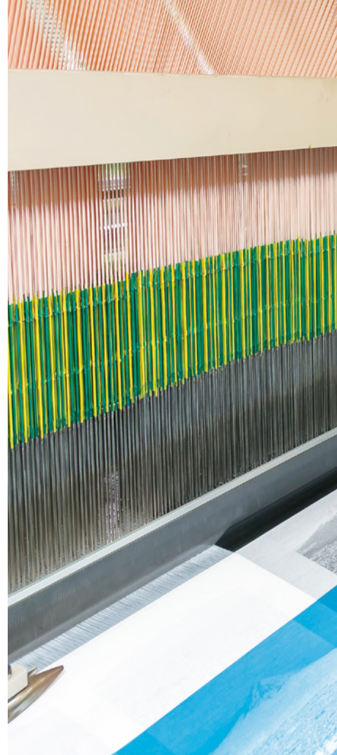
取り込んだ写真の階調を高精度に再現し、織物組織に変換する技術(織物デザ法)を開発。さらに豊かな階調表現を可能にした(上)富士山を背景とした富士吉田市街の風景をジャカード織で再現(下)
