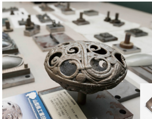
金属3Dプリンターで作られた試作品。金属3Dプリンターにより細かい形状の加工が可能となった
