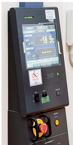
室内温度、マイナス18.5℃を表示(上) マイナス18.5℃の室内(右) 恒温恒湿室の外観(下)
