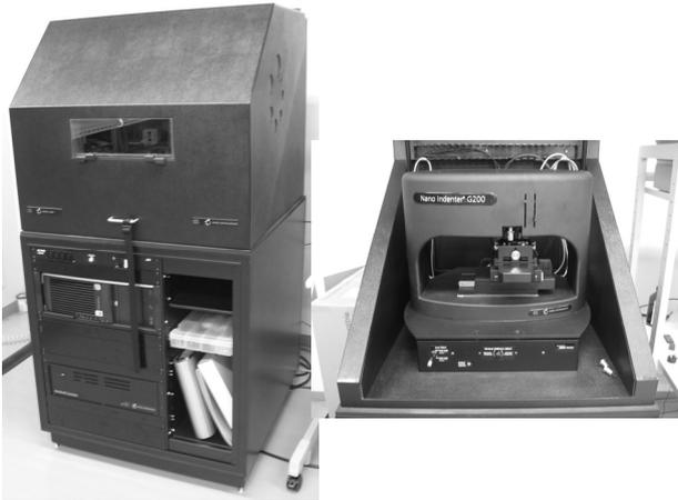
図5 微小押し込み硬さ試験機 (左:外観 右:測定部)
