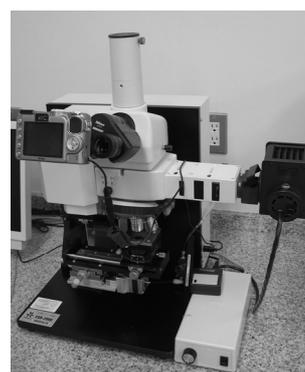
図4 超薄膜スクラッチ試験機
