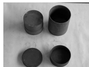
(d) 鋼製ケース（上）とカーボン製焼結ボックス
