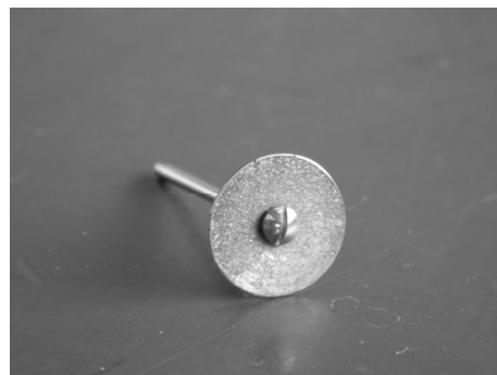
図3 試作工具（リユータ用工具）
