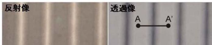
図2 パターンングしたアルミニウム薄膜の観察結果
