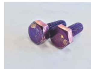
380℃で処理した六角ボルトの色むら
