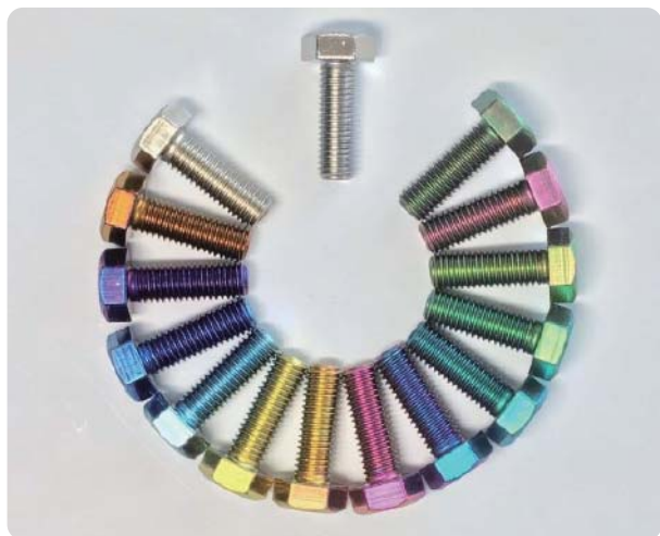
熱処理により様々な発色した六角ボルト (上部は処理前、外周は処理後)
