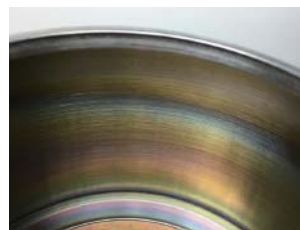
ステンレス製鍋に見える酸化皮膜の干渉色
