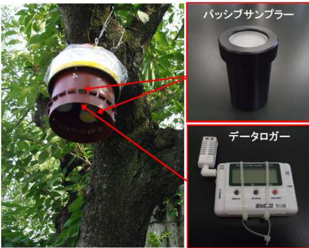
図 3 パッシブサンプラー、データロガーの設置状況
