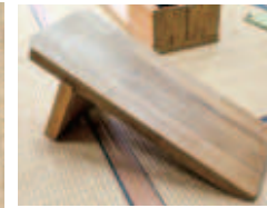
切板（はねいた）と呼ばれる作業台。ザルを編む時に使用する台。斜めに傾いた台で、長さ40cm、高さは15cmほど。
