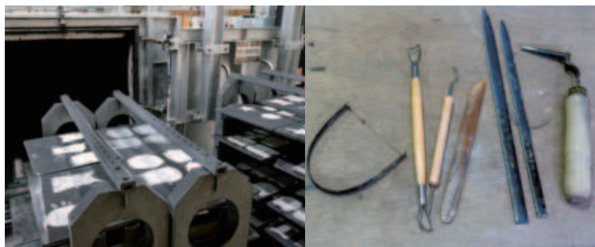
瓦を焼成する窯。焼化によりいぶし銀に仕上がる。
