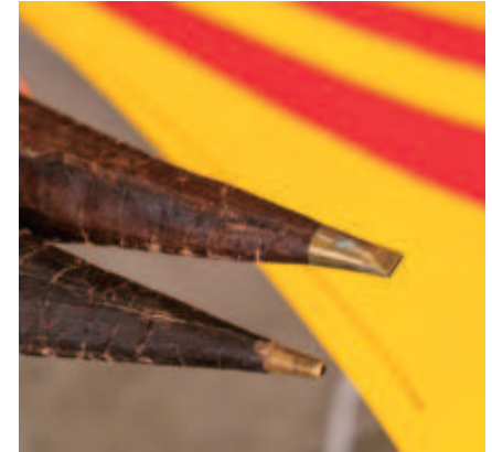
糊置きに使う糊筒。柿渋を塗った和紙の筒に口金を付ける。 口金は形状・サイズが様々なものを使い分け、調整する。
