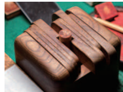
「篆刻台(印床)」印章を制作するときに印材を固定する道具。
