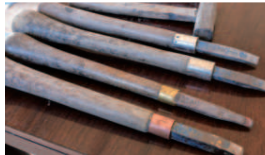
さまざまな先端形状を持つのみを使い分けて、ふちから細部へ削っていく。のみを肩に当て、全身を使って削る。
