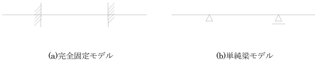
図-3.2.70 床版の死荷重による曲げモーメントを算出するための解析モデル
