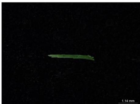
桃林橋で採取した MPs (PP、押出成型)
