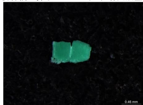
大橋で採取した MPs (PP、射出成型)
