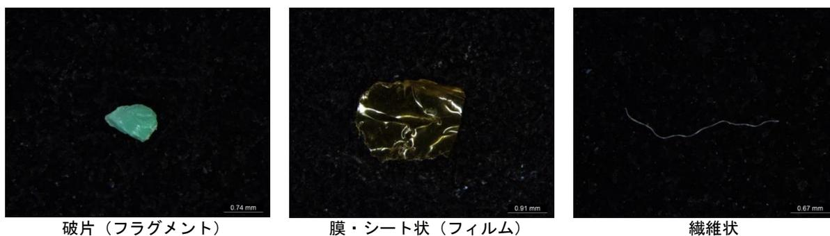
図 3.3-1 採取されたマイクロプラスチックの形状
