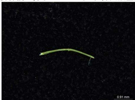
大橋で採取した MPs (PP、押出成型)
